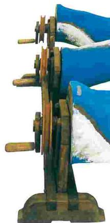
Esta mítica máquina de oleaje de mar se ha reproducido a escala real. Consta de tres cilindros retorcidos sobre sí mismos -o salomónicos- dispuestos en altura que aumenta de forma progresiva hacia el fondo para elevar la línea de horizonte. Este modelo fue difundido por toda Europa en 1638 con el tratado de Nicola Sabbattini. El efecto de mar en movimiento se consigue de manera sorprendente al hacer girar los rodillos de forma simultánea en la misma dirección.
